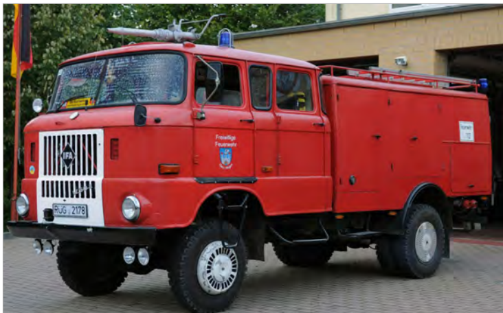
Das Tanklöschfahrzeug „TLF 16/20“ hat einen Wasservorrat von 2.000 Litern. In Garz und Umgebung ist der Weg zu einer Wasserstelle oft weit, da ist dieser Wasservorrat häufig lebensrettend. Nur so kann schnelle Hilfe gewährleistet werden.
